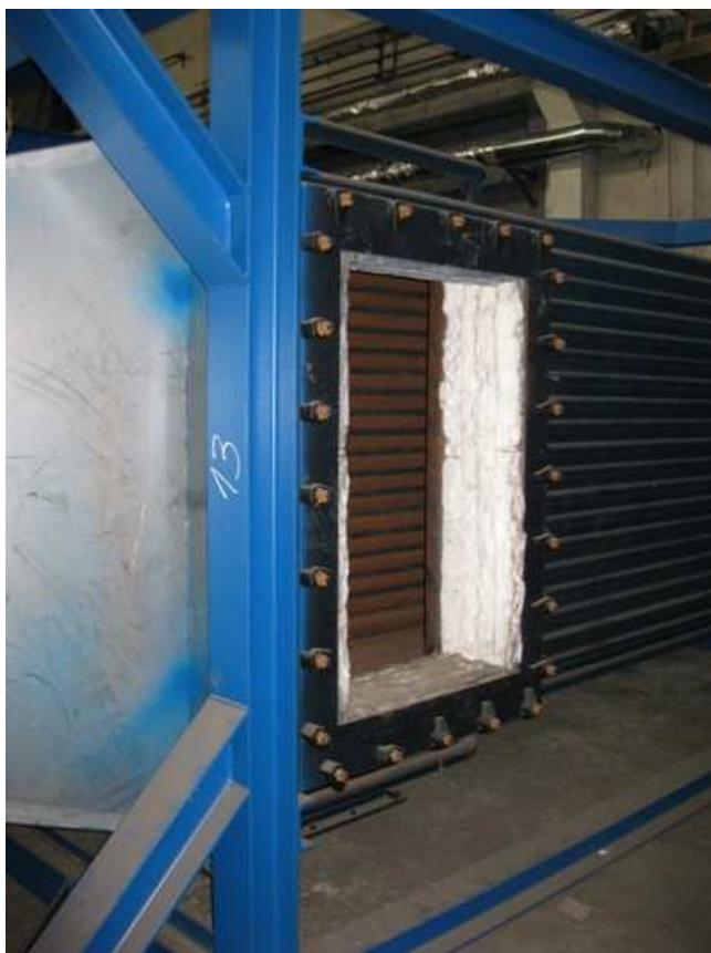
Kocioł na konstrukcji stalowej
