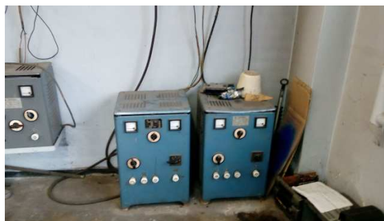
Stół probierczy do badania prądnic i rozruszników SO w Opolu
