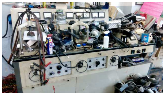
Stół probierczy do badania prądnic i rozruszników SO w Opolu
