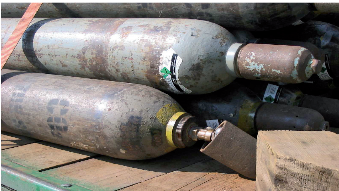
Zdjęcie nr 13 Brak zabezpieczenia ładunku.
