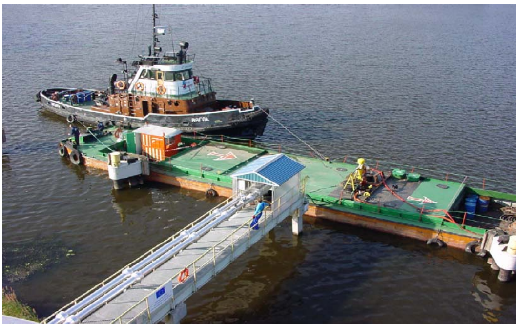
Fot. 3. Odbiór wód zaolejonych na Ostrowie Grabowskim w Szczecinie
