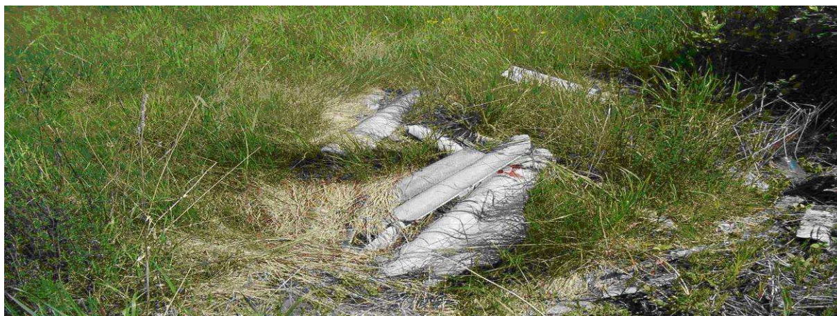
Fot. Nr 9. Porozrzucane odpady wyrobów azbestowych na terenie Agencji Nieruchomości Rolnych w Brzeźnie, Gmina Dorohusk
